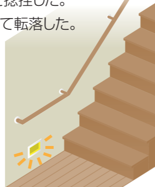
手すりと足元灯
